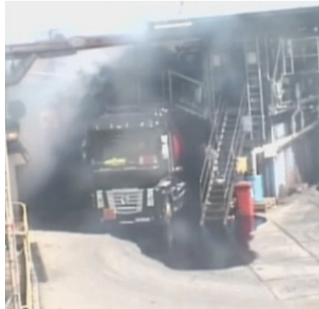
Övervakningsfoto av en våldsam överkokning av bitumen från en tankbil.
